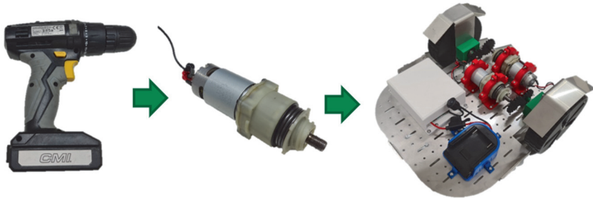
Abbildung 2: Use Case Wiederverwendung von Elektromotoren in neuen Produktgenerationen: links: gebrauchter Akku-Schrauber, mitte: extrahierter Elektromotor inkl. Getriebeeinheit, rechts: Liefer-Rover mit gebrauchten Komponenten
