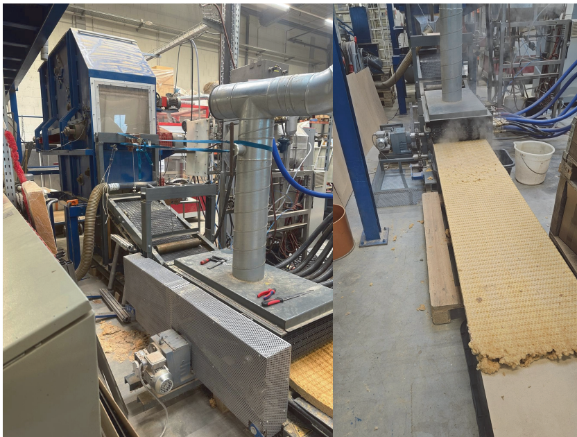
Abbildung 5: Aktueller Anlagenaufbau und damit hergestellte Holzfaserdämmplatte
