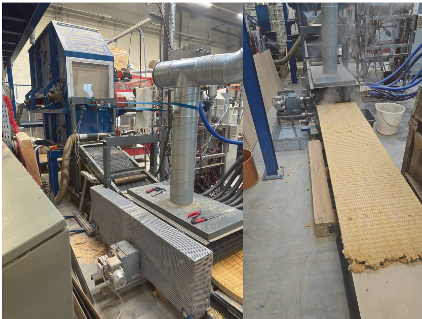
Abbildung 5: Aktueller Anlagenaufbau und damit hergestellte Holzfaserdämmplatte
