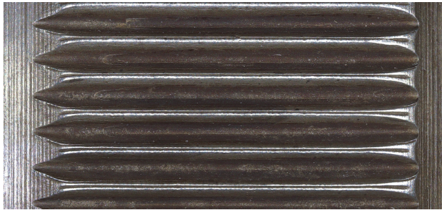
Abbildung 2: gewalzte Rändelung der Versuchsteile
