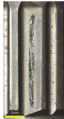
Abbildung 7: Verdrehkennlinien vom Klemmrollenfreilauf mit Kreisbogenrampe und typisches Schadensbild nach Versuchsende
