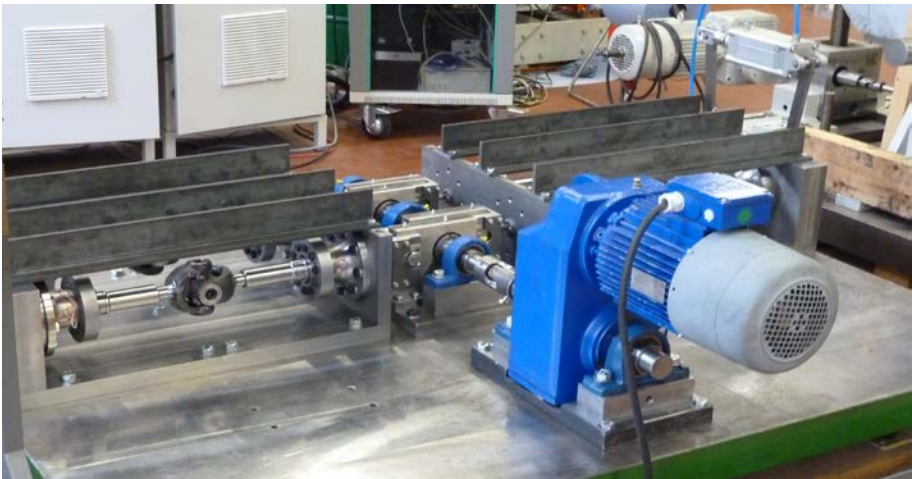
Abbildung 1: Prüfstand zur Ermittlung von Reibungs- und Verschleißkennwerten in Zahnwellenverbindungen
