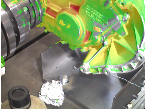
Abbildung 3: Temperaturanalyse eines Getriebegehäuses
