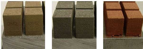
Bild 1: Elektroden aus v.l. Bronze-, Stahl- und Kupfer-Pulvermischungen
