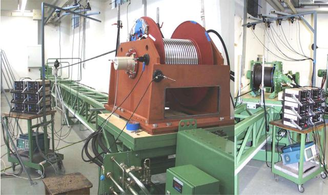
**Bild 6:** Seiltrommelprüfstand mit Telemetrie
