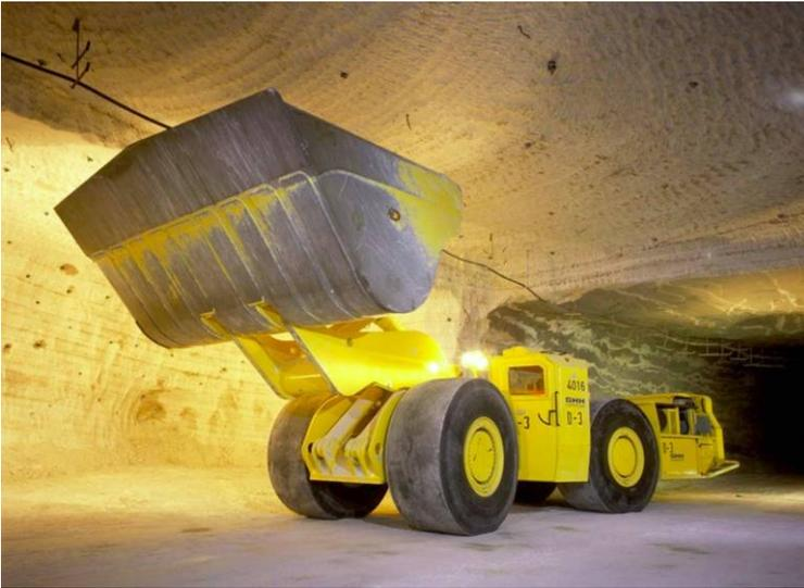
**Bild 1:** GHH Fahrlader des Typs LF-17/21 am Standort Zielitz /4/
