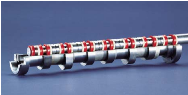
Bild 4: Werkzeug zur Herstellung der gebauten Nockenwelle /7/
