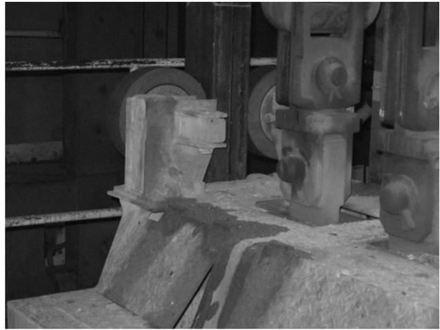
**Bild 5:** Ansicht des Kopfes des Schachtfördergefäßes mit Seitenführungen
