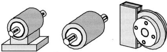
Bild 1: Bauformen rotierender DMS-Drehmomentsensoren /4/
