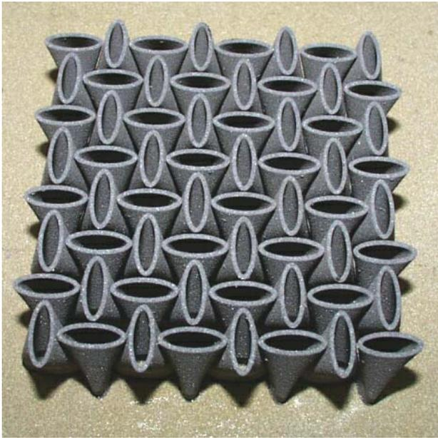
**Bild 2)** lasergesinterte Strukturelemente
