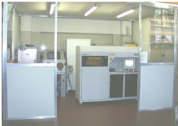
Bild 1: Rapid Tooling Anlage EOSINT M 250
