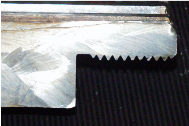
Bild 2.1: Gestufte Nabe mit Verzahnung nach DIN 5480
