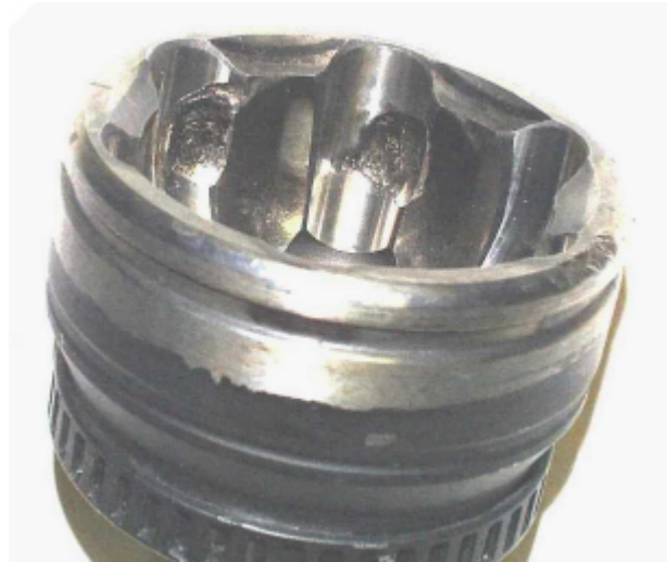
Bild 7: Pitting und Kantenabbrüche der Kugellaufbahnen im Gelenkstück nach ca. 23 Mio. Lastwechseln
