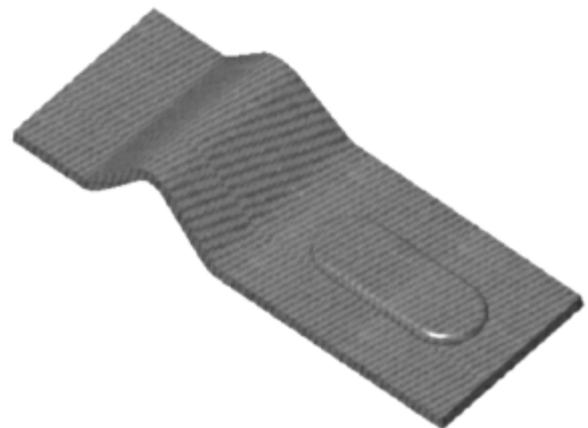
**Bild 6:** Probebauteil aus Faserverbund
