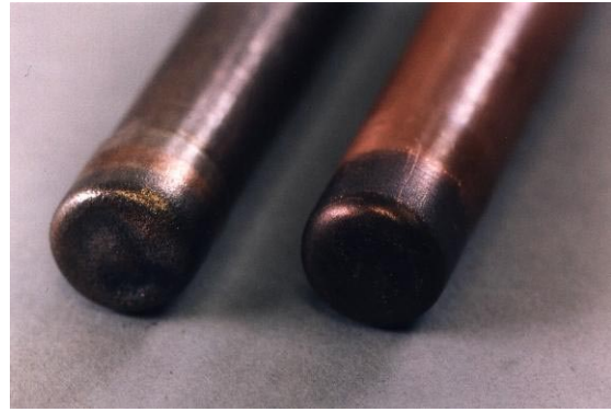
Bild 2: Elektroden (li: Rapid Steel 1, re: Kupfer)
