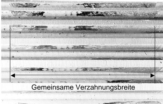
Bild 2: Flankenoberfläche in der Einlaufverschleißphase
