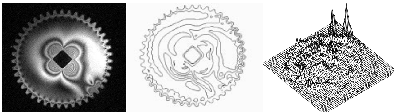
Bild 4: Auswertungsschritte von links, Isochromatenbild, extrahierte Isochromaten, Spannungsverteilung nach der GEH
