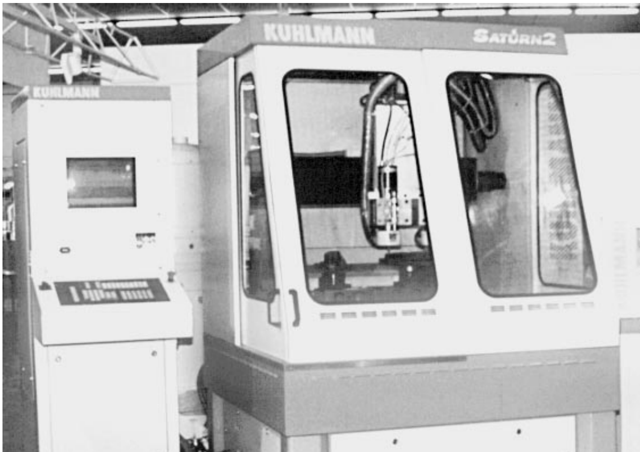
Bild 2: Realisierte Aabsaugungsanlage an einer Saturn 2
