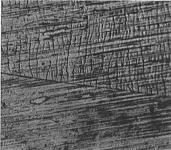
Bild 2: Versetzungen benachbarter Kristallite von AgCl
