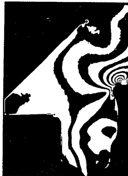
Bild 16: Pressenständer. Isochromatenbild an der Kerbstelle, räumlicher spannungsoptischer Versuch.
