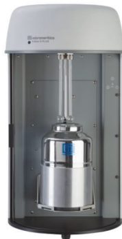
Abbildung 10: TriStar II Puls von Micromeritics GmbH /10/
