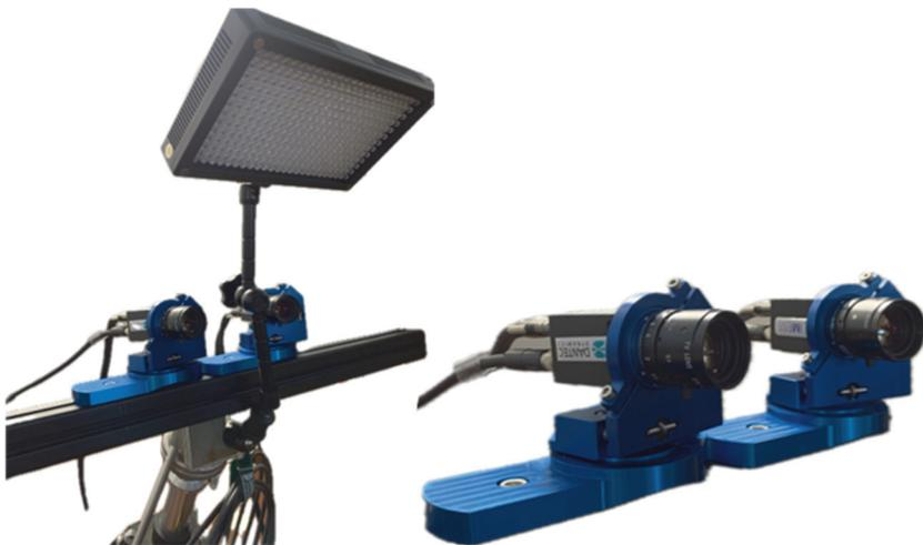
**Abbildung 2:** DIC Messaufbau mit Kameras, Stativ und LED-Beleuchtung
