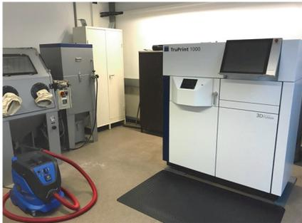
**Abbildung 2:** Lasersinteranlage
