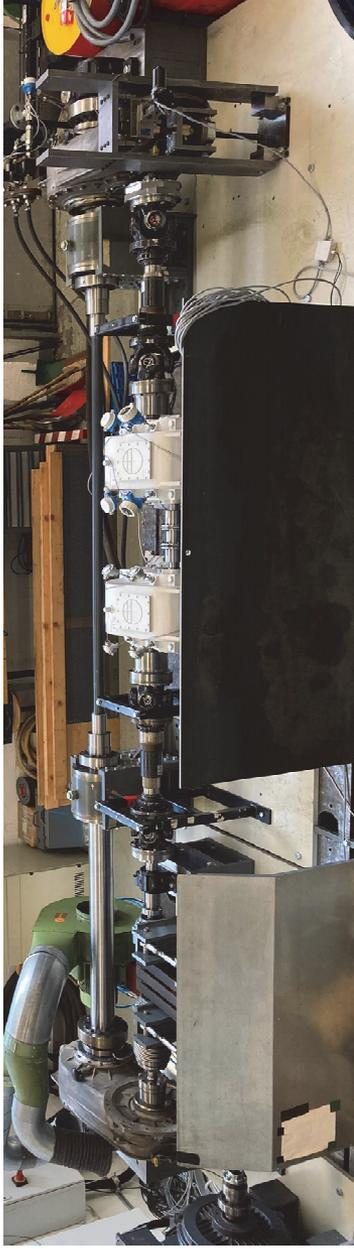
**Abbildung 1:** Übersichtsfoto des MW-Verspannprüfstands
