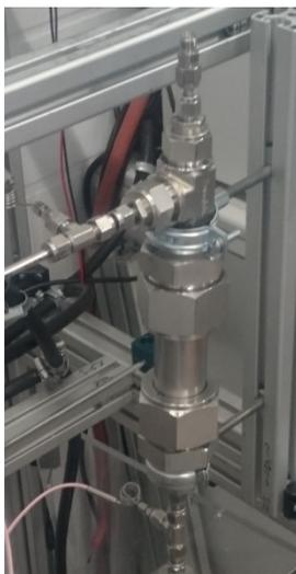
Abbildung 1: Produktabscheider mit vielen Adaptern (ICVT<sup>2</sup>)
