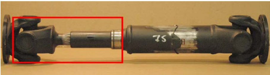
Abbildung 6: Gelenkwelle als Prüfteil für die Hauptuntersuchungen. Rot markiert ist der verzahnte Längenausgleich als Prüfteil für die Vorversuche.
