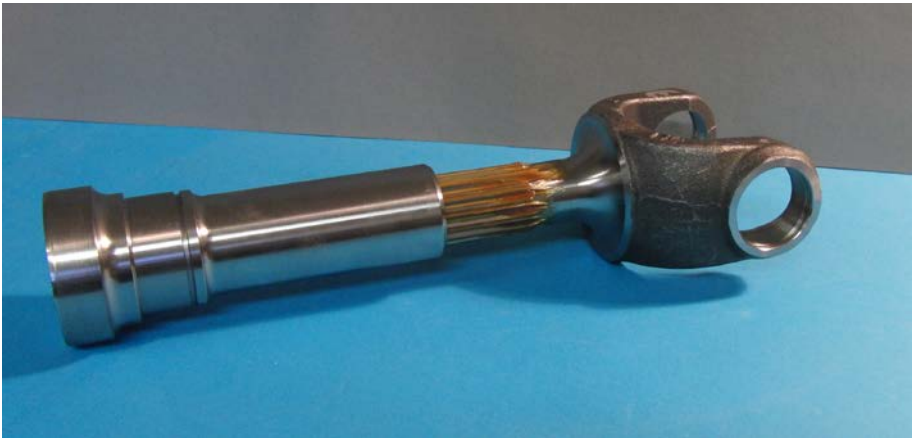
Abbildung 3: Prüfungsgeometrie - Zahnwellenverbindung mit Gelenkgabel an verzahnter Welle.
