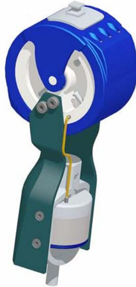
lung einer lastabhängigen Bremse für prothetische Kniegelenke, wobei natürlich die systematische Vorgehensweise nach der Konstruktionslehre im Vordergrund stand.
