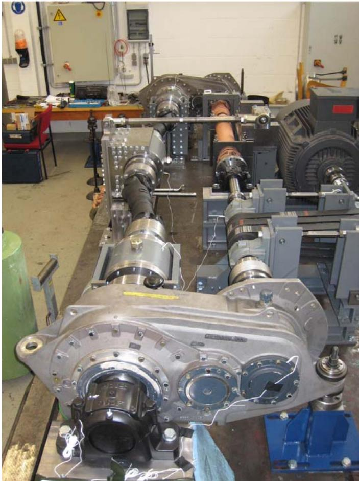
**Bild 2:** Der ausgeführte „große Gelenkwellenprüfstand“
