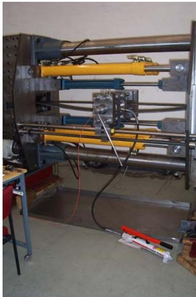
**Bild 1:** Seilprüfstand
