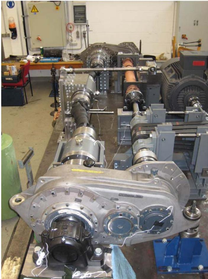
**Bild 2:** Der ausgeführte „große Gelenkwellenprüfstand“
