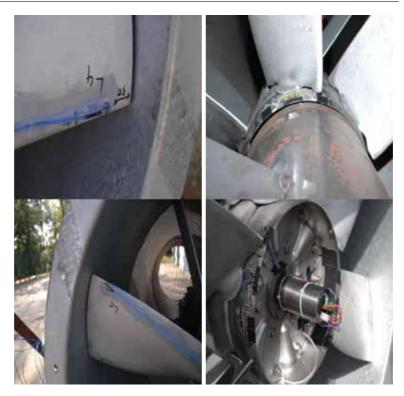
**Bild 3:** Sensorposition des einachsigen (L4) und dreiachsigen (L5) Beschleunigungsaufnehmer direkt auf der Schaufel (linke Spalte). DMS Position 1 und 2 sowie 3 und 4 auf der Halbschale zur Spannungsermittlung und Flansch zur Aufnahme des Telemetriesenders (rechte Spalte).
