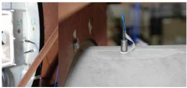
**Bild 2:** Sensorpositionen der einachsigen Beschleunigungsaufnehmer auf dem Gehäuse.
