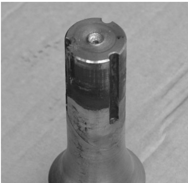
Bild 8: Längsstiftprobe nach Wechseltorsionsprüfung
