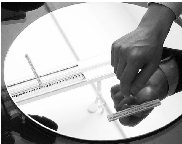
Bild 3: Musikalischer Spiegel (LOA). Durch Klopfen an unterschiedlichen Positionen des Spiegels kann die Tonhöhe eines akustischen Signals verändert werden.
