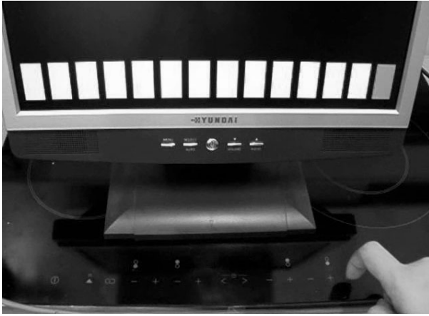
Bild 2: Interaktives Kochfeld. Monitor zeigt, dass die Berührpositionen erfolgreich detektiert werden (Quelle: UWC).
