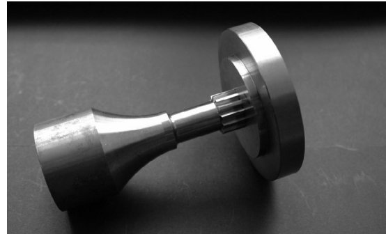
Bild 6 Prüfling und Nabe im gefügten Zustand
