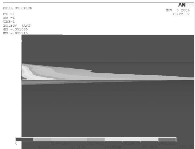
Bild 3: Plastische Verformungen in der Nabe längs der Stiftbohrung bei 1000 Nm Torsion
