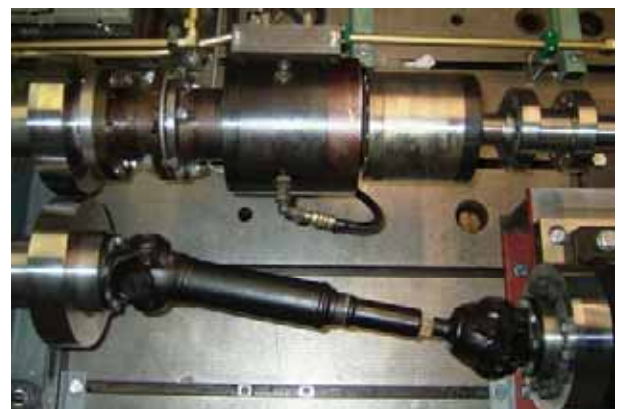
Bild 7: Gelenkwelle in Z-Anordnung mit 10° Beugewinkel im Prüfstand
