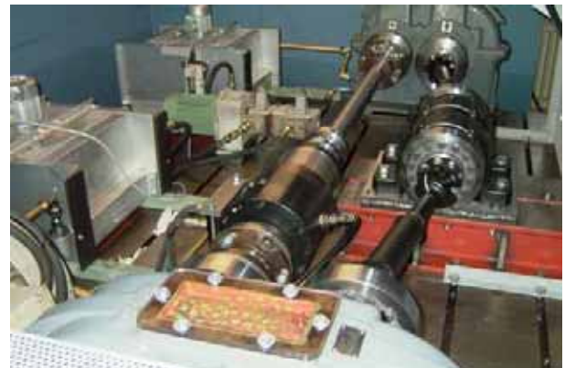
Bild 6: Gesamtansicht des kleinen Verspannprüfstands, 300 kW umlaufende Leistung
