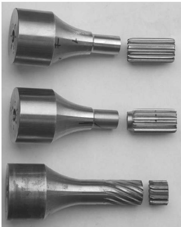
**Bild 6:** Zahnwellenproben aus statischen Gestaltfestigkeitsversuchen
