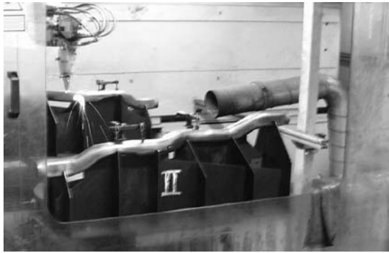
Bild 5: 3D-Laserschneidanlage mit einteiligem Ausgangsprofilrohr im Vordergrund
