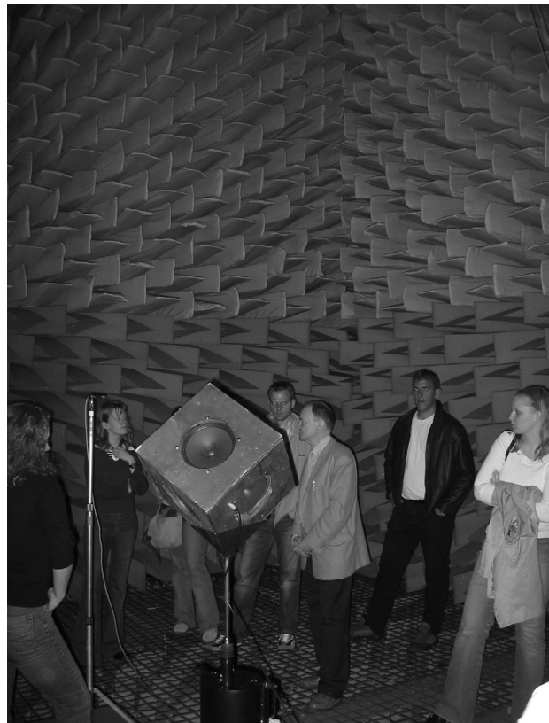
Bild 2: Schalltoter Raum für akustische Versuche.
