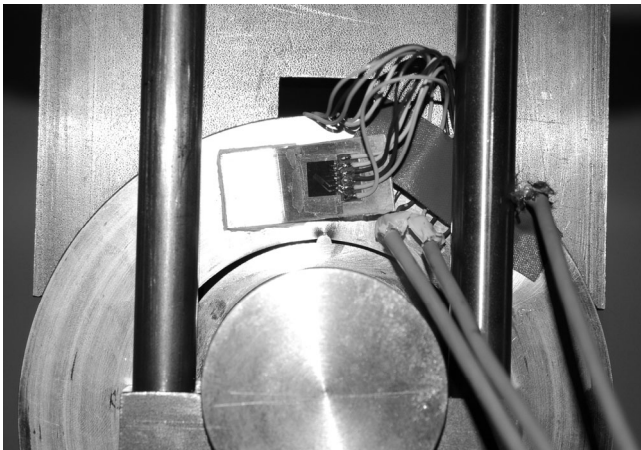
Bild 8: Umformprozess einer Nabe mit Novikovstempel
