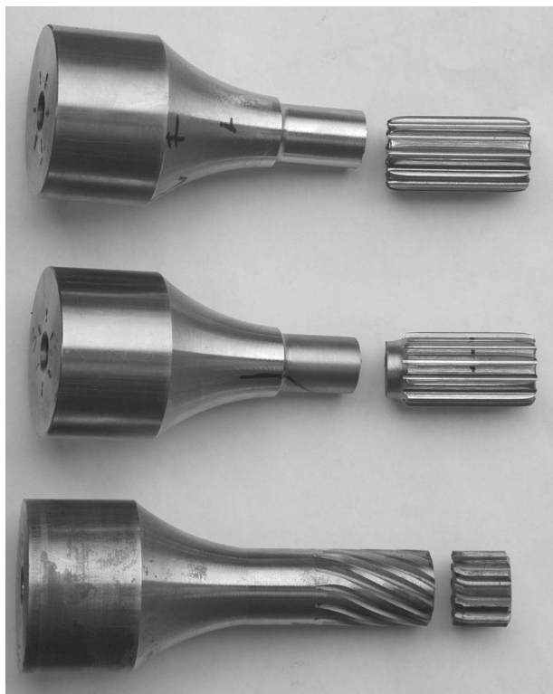
Bild 6: Zahnwellenproben aus statischen Gestaltfestigkeitsversuchen
