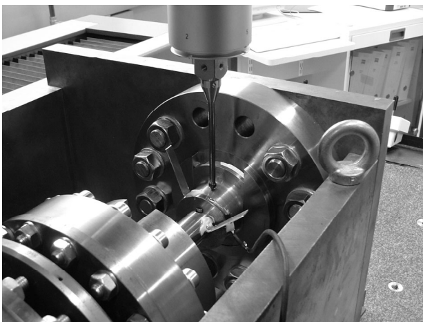
Bild 4: Messung an einer Passfederverbindung
