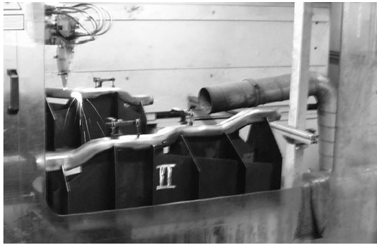
Bild 5: 3D-Laserschneidanlage mit einteiligem Ausgangsprofilrohr im Vordergrund
