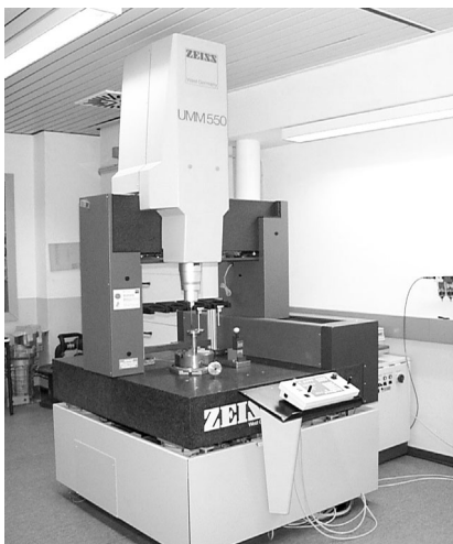
Bild 1: Koordinatenmessgerät des IMW
