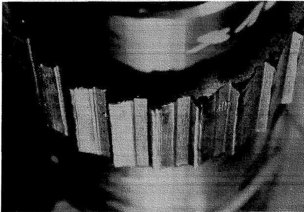
**Bild 1.2** Verschleiß an einer überwiegend durch Drehmoment beanspruchten Zahnwellenverbindung
