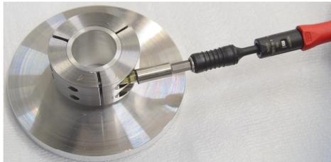
Abbildung 3: Montage eines Stützrings an einer dünnwandigen Aluminium-Nabe mit  $l_F=15mm$
