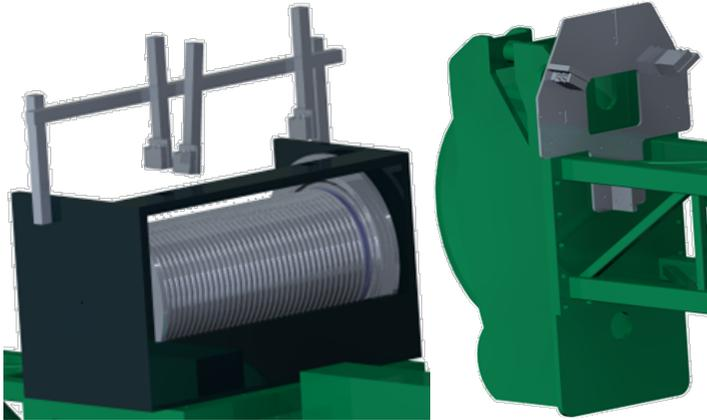
Abbildung 3: Exemplarische Anordnung von Laser Profil Scannern zur Untersuchung des Seilpaketes auf der Trommel (links) und Aufbau zur Untersuchung der Seilverformung am freien Seil nahe der Seilscheibe (rechts)
