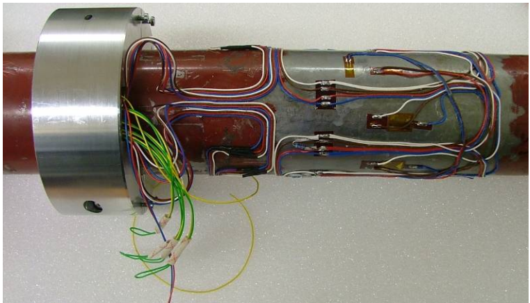
Bild 3: Gelenkwelle mit applizierten DMS zur Messung von Drehmoment, Biegemoment und Axialkraft. Außerdem ist ein Ring zu erkennen, der den Telemetriesender sowie die Spannungsquellen für die Sensorversorgung aufnimmt.
