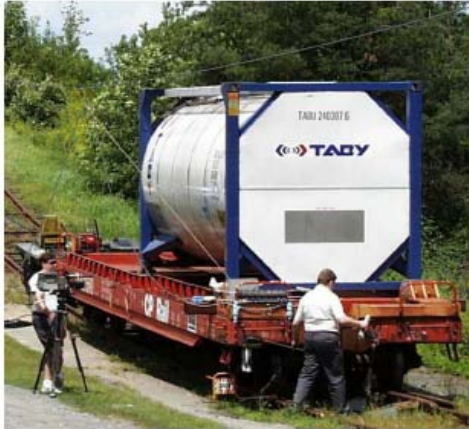
Bild 5: Versuchsstand des Systems aus Schienenwagen und Tankcontainer für den dynamischen Auflaufstoß-Test /5/
