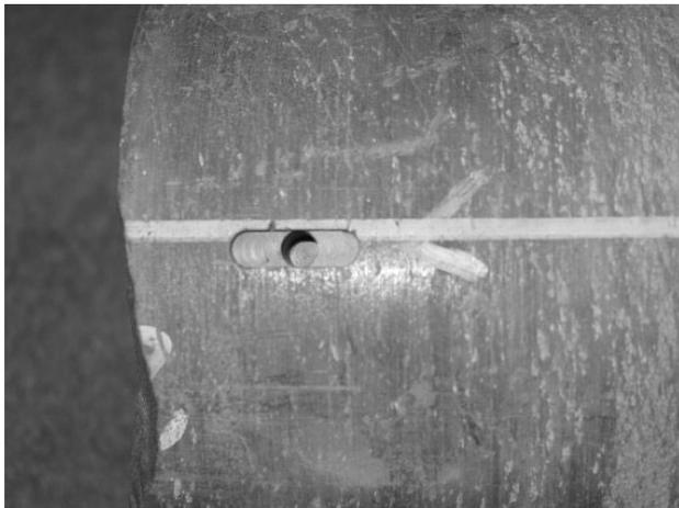
**Bild 2:** Bohrung und Nut an einer Tonsteinprobe
