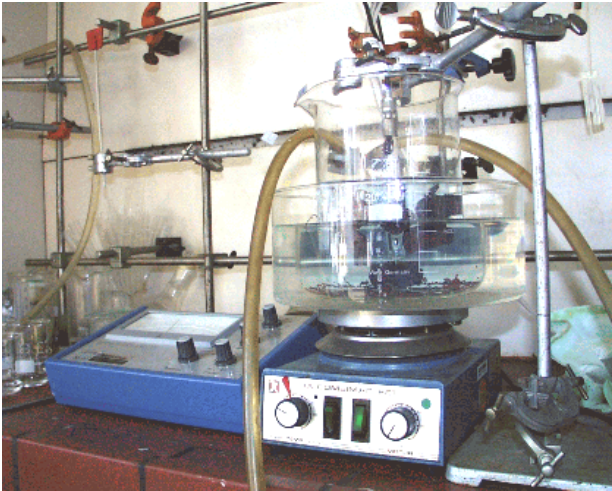
Bild 1: Laboraufbau zum chemischen Beschichten
