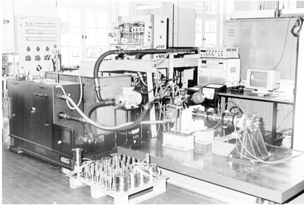
**Bild 10:** Servohydraulischer Prüfstand für Bauteiluntersuchungen bei reiner Drehmomentbelastung
