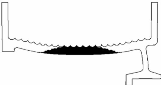
**Bild 12:** Erste Durchplastifizierung des Mantels bei  $p(x)/p_{ge} = 1,05$
