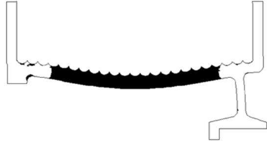
**Bild 14:** Ausdehnung der plastifizierten Zone bei  $p(x)/p_{ge} = 1,33$
