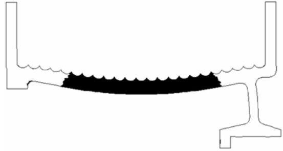
**Bild 13:** Ausdehnung der plastifizierten Zone bei  $p(x)/p_{ge} = 1,12$
