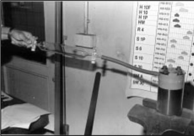
**Bild 3:** Entnahme einer Gasprobe
