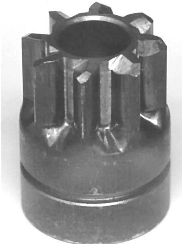
**Bild 1:** Zahnkantenabdachungen an einem Anlasserritzel
