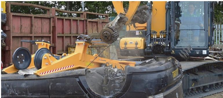
*Abbildung 1: Entnahme einer Antriebswelle im Rahmen einer maschinengestützten, manuellen Zerlegung eines Altfahrzeuges /2/*
