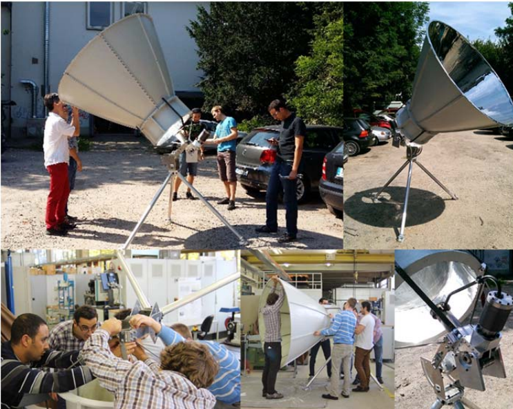
Abbildung 2: Prototyp des Solar-Stirling-Motors
